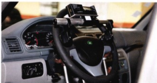
Данные с уровня, установленного на руле, получает оператор, находящийся под машиной, и сверяет их с углами установки колес
