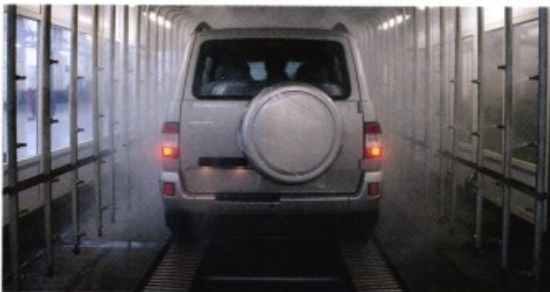
После прохождения «дождевой» камеры у всех автомобилей некоторые объемы проверяют на герметичность
