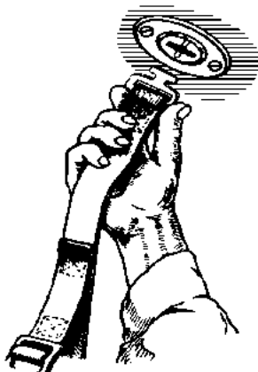
Рис. 3.12. Установка подвесного ремня
